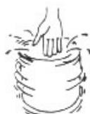
脫水時，打開蓋子，15秒鐘以內脫水槽沒有停止時，請立即停止使用並委託修理。
