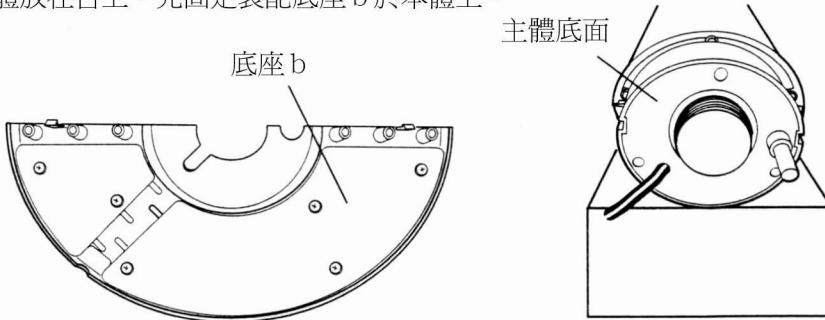
2、裝配時，請在底座 b 的突起部分（6 個部分）上插入底座 a 的突起部分。
