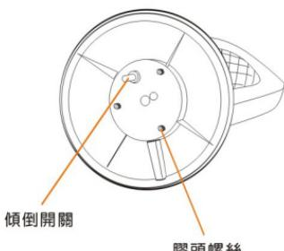
※本體提起傾倒時，傾倒開關即時動作，請切斷電源，避免發生危險。
