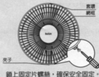
5. 前網的網圈套環對準後網壓鈕的位置，再將夾子壓入，使前、後網合在一起。
