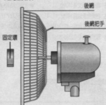
3. 後網把手朝上，後網三個缺口對準馬達前凸出三個小柱，將後網緊貼馬達，以固定環套上，並向右鎖緊。
