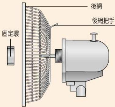
3. 後網把手朝上，後網三個缺口對準馬達前凸出三個小柱，將後網緊貼馬達，以固定環套上，並向右鎖緊。
