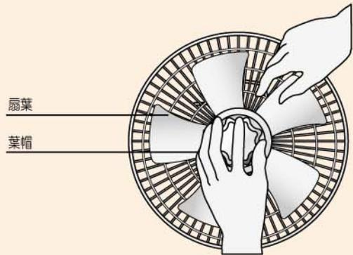
4. 將扇葉插入馬達轉軸後緊貼，再以葉帽栓緊（由右向左）。
