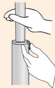
6. 高度調整時，可按下高度調整鈕，調整伸縮管至想要的高度。
