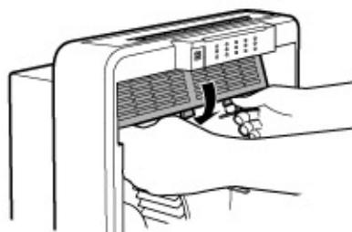
先將電漿電極板上側的掛勾掛好後，再把下側往內押緊即可。
