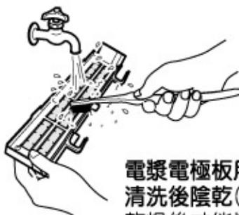
電漿電極板用水清洗後陰乾(徹底乾燥後才能裝上)
