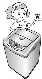
請檢查進水管接頭處的橡膠墊。
