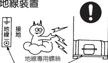
請在冰箱左下方專用螺絲裝上地線於⊕記號上並把地線另一端埋入地下或是焊於牆壁中的鋼筋避免發生漏電，地線地可以到市面上購買銅線直徑1.6mm地線安裝或請洽詢購買商店或服務站。
