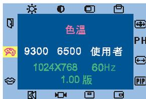
當您在色溫中選擇「使用者」模式時，請按主機體上的「MENU」或遙控器上的“▶”鈕進入第二頁調整紅（R）綠（G）藍（B），調整完畢後再按主機體上的「MENU」或遙控器上的“▶”鈕返回主目錄。
