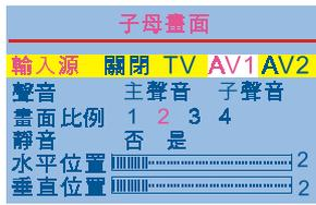
當您選擇“PIP”時，請按主機體上的「MENU」或遙控器上的“▶”鈕進入第二頁，調整完畢後再按主機體上的「MENU」或遙控器上的“▶”鈕返回主目錄。
