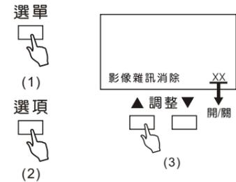
進入“影像雜訊消除”項目，再按調整▲/▼即可輕易控制畫面影像雜訊消除的開/關功能
