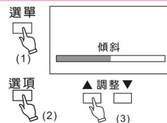
進入“傾斜調整”項目，您再按▲/▼調整。傾斜調整之工廠設定值為中間值，功能是為了消除因地磁影響畫面傾斜之狀態，電視機會因其擺設方向的不同而有不同之傾斜程度。
