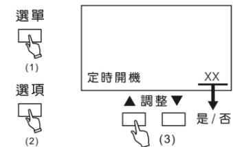
進入“定時開機”調整項目，再利用▲ / ▼即可調整您所設定的開機時間，電視將會在您所設定的時間開機，且自動跳到您所設定的開機頻道(此時如果您正在觀看其他頻道將會切換至開機頻道)若停電後，此功能將會自動消失。若要在執行，需將重新設定時間。
