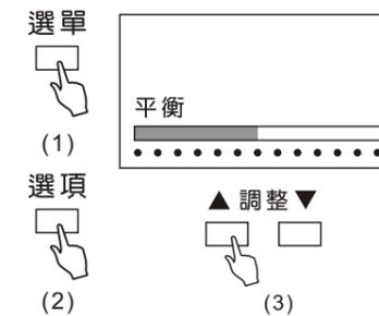
進入“平衡”調整項目再按▲/▼即可調整左右聲道平衡
