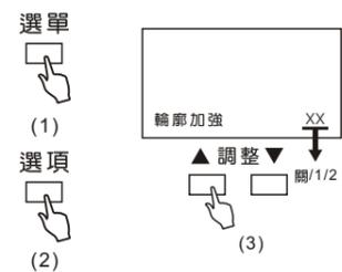
進入“影像輪廓加強”項目，再按調整▲/▼即可輕易控制畫面影像輪廓加強的1(強)/2(中)/3(弱)/關功能
