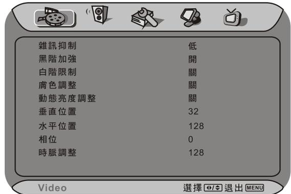
(垂直位置/水平位置/相位/時脈調整僅在VGA模式下使用)
